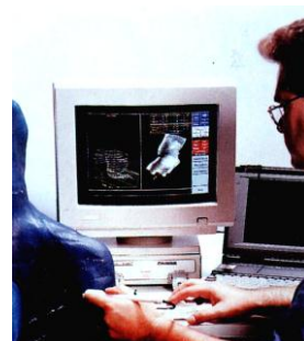
図9 CADによるシート の形状データの入力 (OttoBock社)
