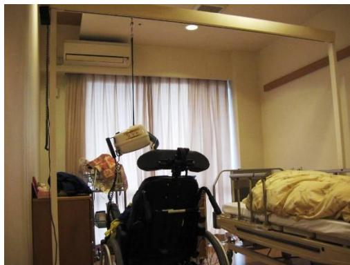
図 4-1 個室での据え置き型。使いたい居室に移動し組み立てができる。シーツ交換やベッドの下の掃除がしやすい。
