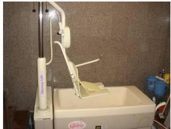
図 3-4 狹い浴室にも適した個別浴槽対応型
